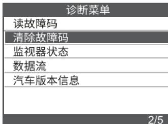
2.2根据上图按[确认]键，屏幕将显示如下界面：
