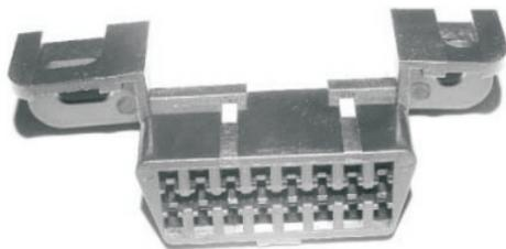
汽车诊断座的位置一般在驾驶方向盘的左下方或者右下方。如下图：
