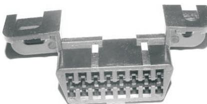
汽车诊断母座的位置一般在驾驶方向盘的左下方或右下方。如下图：
