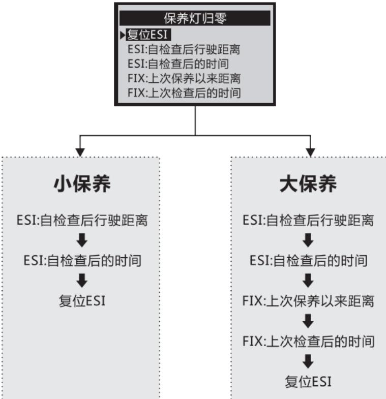
按照以上步骤操作完成以后，成功完成保养灯归零，请断电再重启车辆。
