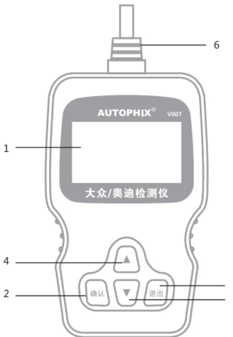
1. “液晶显示” —— 显示测试结果。背光， $128 \times 64$ 像素显示屏，支持对比度调节。
